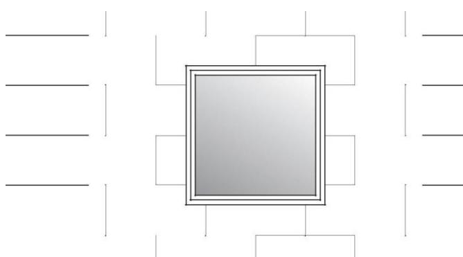
Ploče lepiti tesno jednu uz drugu tako da lepak ne dospeva na kontaktne površine između dve EPS ploče. Eventualne pukotine zapuniti komadićima EPS ploče, ili niskoekspandirajućom pur penom za tu svrhu BK-PUR EPS Kleber Gun, a nikako lepkom.
