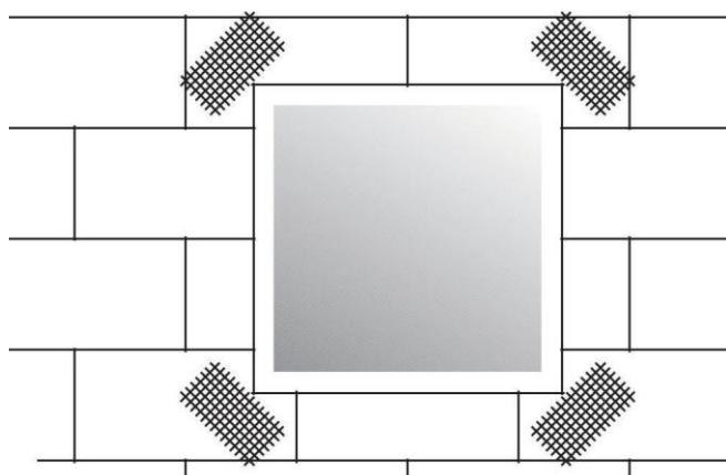
Da bi sprečili eventualnu pojavu dijagonalnih pukotina na uglovima otvora, pre početka armiranja celokupne fasadne površine potrebno je izvršiti prethodno armiranje po uglovima otvora. Armiranje se vrši pomoću komada fasadne mrežice okvirne veličine min. 30x50 cm koji se postavljaju dijagonalno uz sam ugao otvora. Pripremljeni komad mrežice se polaže u sloj svežeg lepka namenjenog za armiranje, nanetog nazubljenom gletericom (veličina zuba ~ 8-10 mm).
